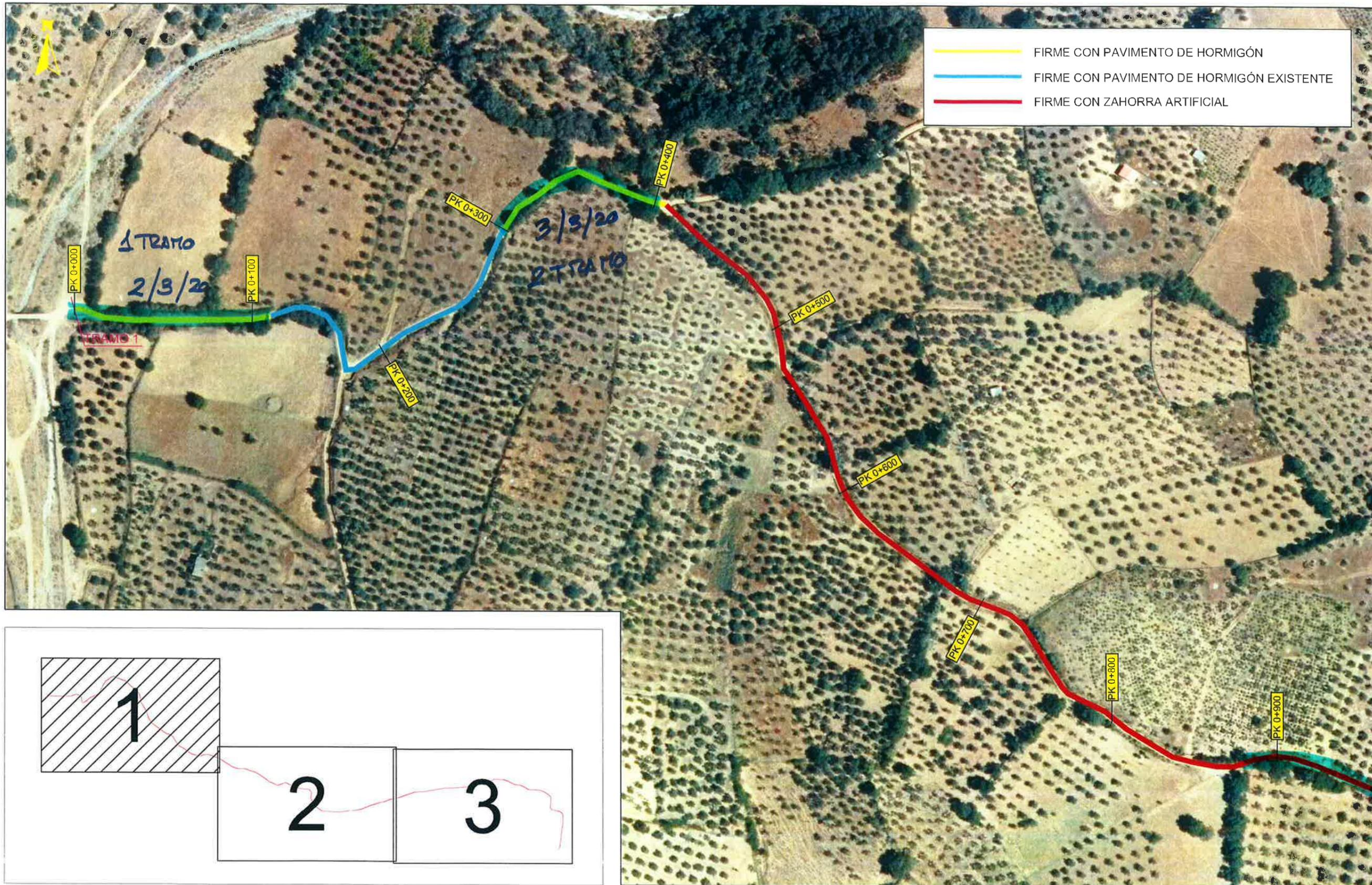
— FIRME CON PAVIMENTO DE HORMIGÓN
