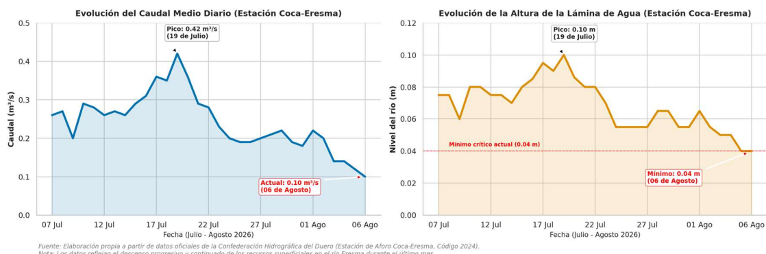
Gráfico 1: Evolución del caudal medio diario (m³/s) y nivel de la lámina de agua (m) en la estación de aforo de Coca-Eresma (07/07/2026 - 06/08/2026). Fuente: Confederación Hidrográfica del Duero.
