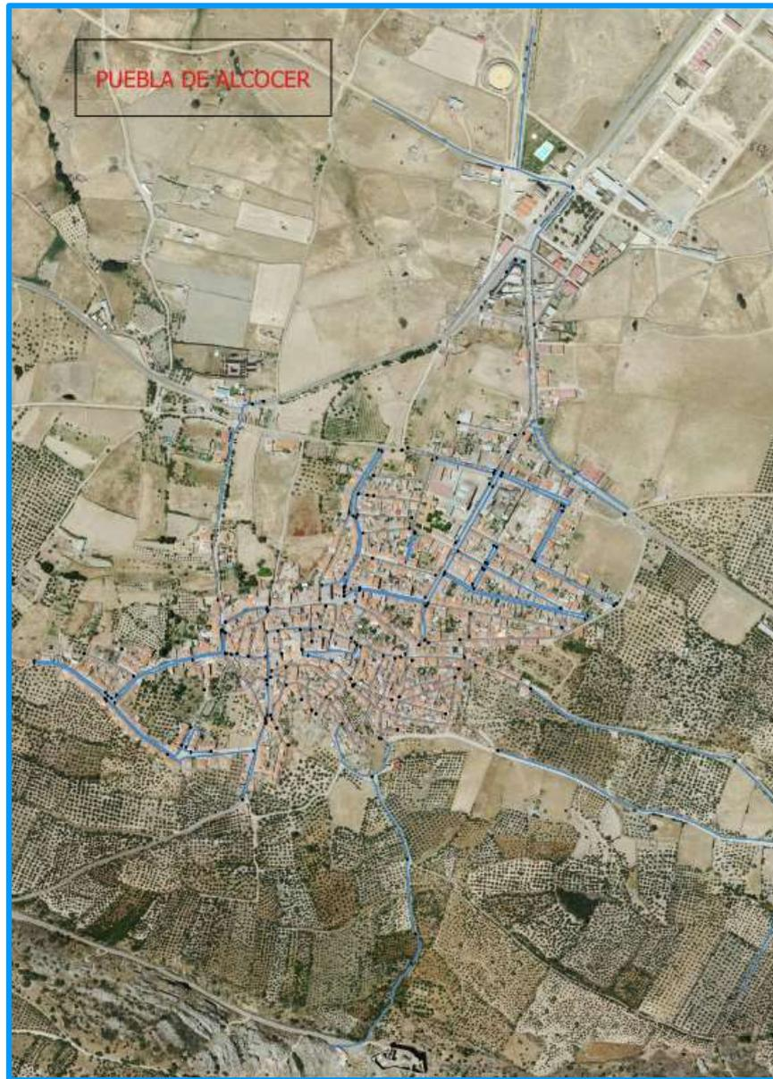
Imagen 51 – Plano actualizado de red de transporte de agua potable del municipio de Puebla de Alcocer. Fte.: Aquanex.
