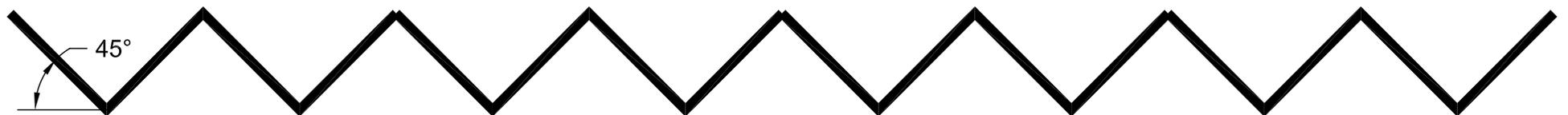
Esquema en planta del Cerramiento de Madera. Listones Verticales en biombo a 90°.
